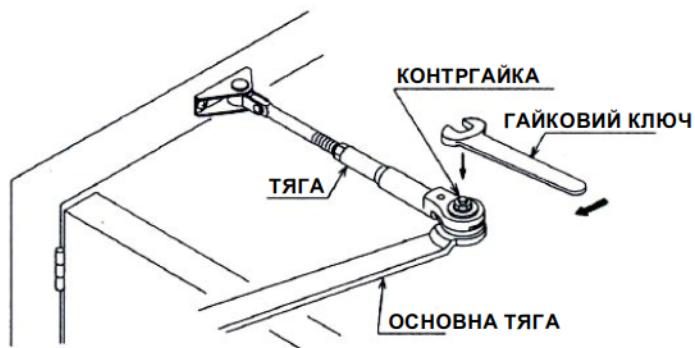
**ПРИМІТКА:** ЯКЩО ГАЙКА НЕ ЩІЛЬНО ЗАТЯГНУТА, ПРИ ОТКРИВАННІ ПРИСТРІЙ ФІКСАЦІЇ МОЖЕ ПОШКОДИТИСЬ.
